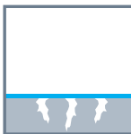
Pontage de fissures
